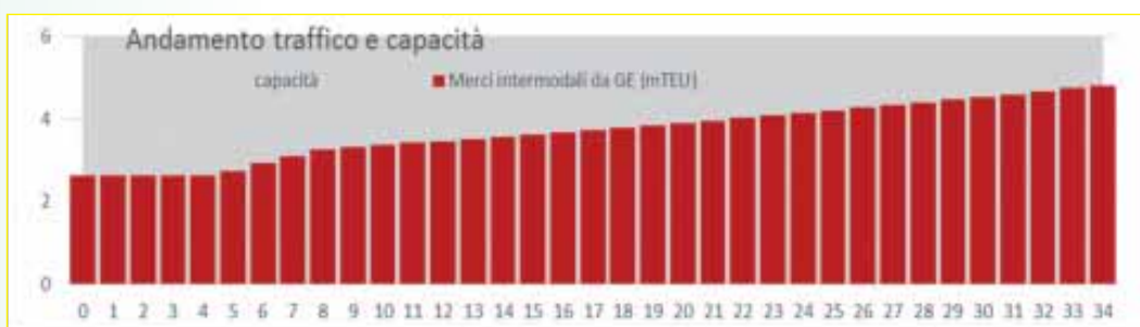
Fig. 10 - Esempio di andamento dei TEU con cap a 6 milioni di TEU (Porto di Genova)
